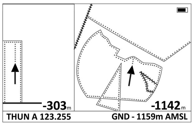
Wenn du dich innerhalb eines Luftraums befindest, geben die beiden Pfeile den kürzesten Weg aus dem Luftraum an. Die angezeigte Distanz ist dann die vertikale/horizontale Distanz bis zur Luftraumgrenze.
