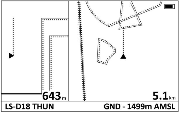
So sieht der Luftraum-Bildschirm des Maxx II aus, wenn du auf einen Luftraum zufliegst. Links ist die Seitenansicht, rechts die Draufsicht. Die Zahlen geben links die vertikale Distanz zum nächsten Luftraum an, rechts die horizontale Distanz zum nächsten Luftraum.
